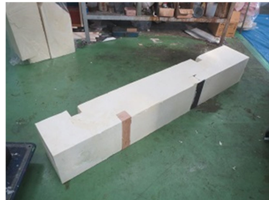
写真-4 充填性試験 (障害物あり)
