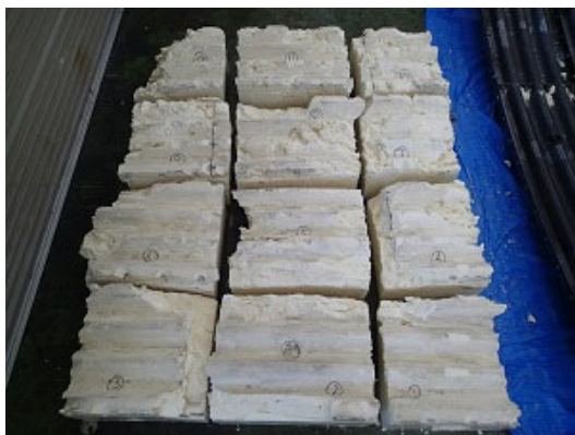
写真-8 解体後充填状況（上面側）
