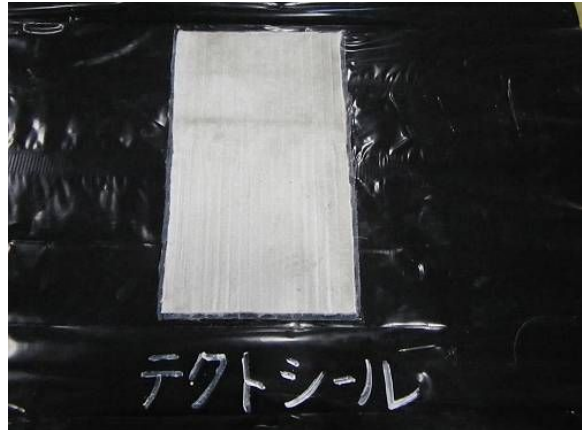
写真-12 初期寸法 (テクトシール)
