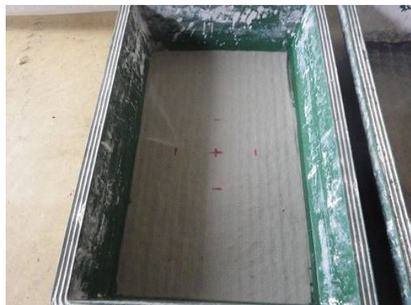
写真-16 膨潤26日後 (テクトシール)
