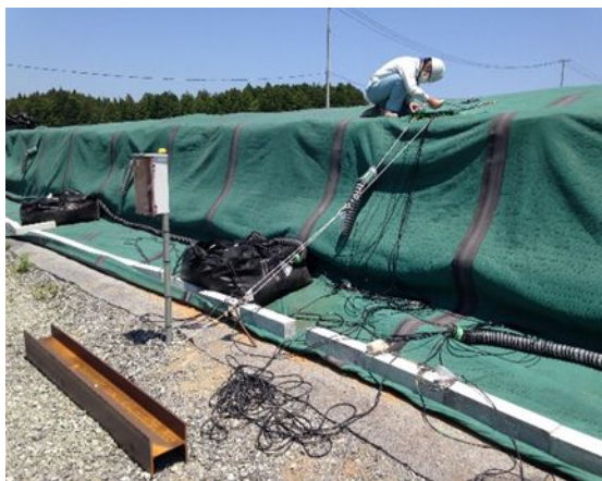
写真-6 ケーブル張力測定装置
