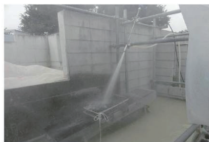
写真-4 促進摩耗試験
