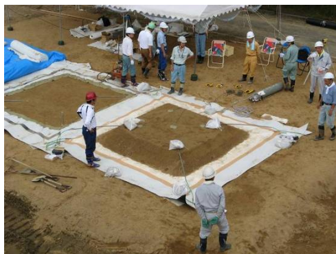
図-9 ガス透過性実証実験の状況
