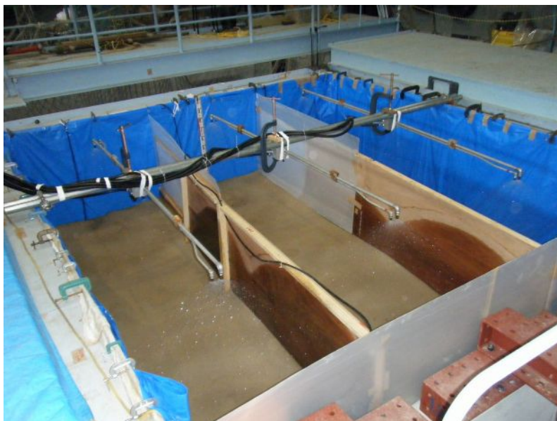
実験に使用した新透水マット（実験の様子）
