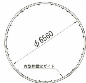
図-10 リングフレーム寸法
