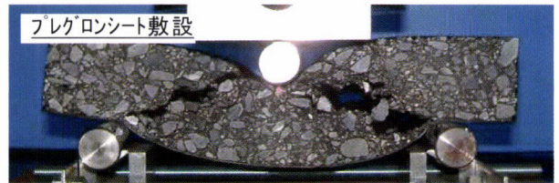
各強化シート敷設供試体のクラック発生状況
