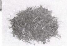
チップ材：長さ15cm以下、幅1cm以下の粉砕処理材を使用。
