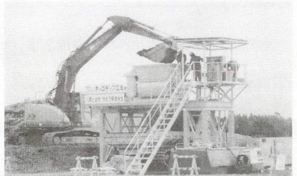
現場発生表土にチップ材と水を加え、十分に混合しながら種子、肥料、接合材、団粒材を添加する。
