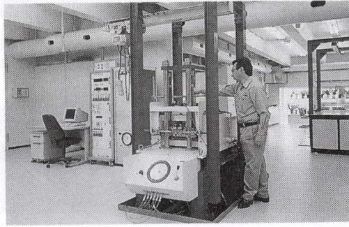
写真-8 大型動的単純せん断試験装置
