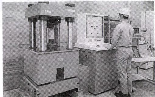
写真-10 2000kN高剛性圧縮試験機
